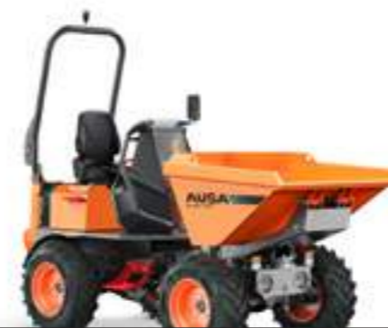
D151AEG 1500KG DESCARGA GIRATORIA POTENCIA 19,6KW ANCHO 1.480MM TRANSMISIÓN ELÉCTRICA
