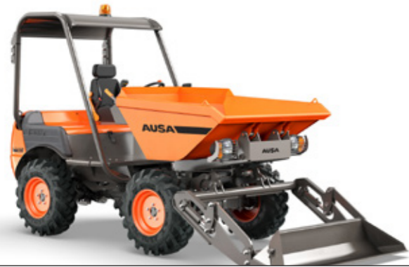
D201RHG/RHGS 2000KG DESCARGA GIRATORIA TRACCIÓN 4x4 POTENCIA 18,5KW ANCHO 1.750MM TRANSMISIÓN HIDROSTÁTICA
