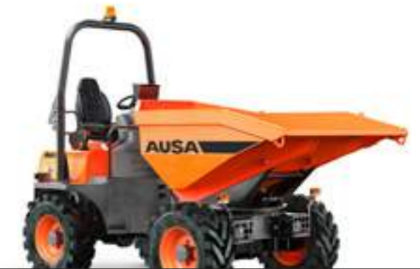
D450AHG 4500KG ENTLADESYSTEM SCHWENK LEISTUNG 32,8KW BREITE 1.870MM KRAFTÜBERTRAGUNG HYDROSTATIK
