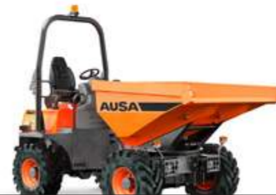
D350AHG 3500KG ENTLADESYSTEM SCHWENK LEISTUNG 32,8KW BREITE 1.850MM KRAFTÜBERTRAGUNG HYDROSTATIK
