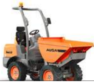
D100AHA 1000KG ENTLADESYSTEM HÖHE LEISTUNG 15,6KW BREITE 1.100MM KRAFTÜBERTRAGUNG HYDROSTATIK
