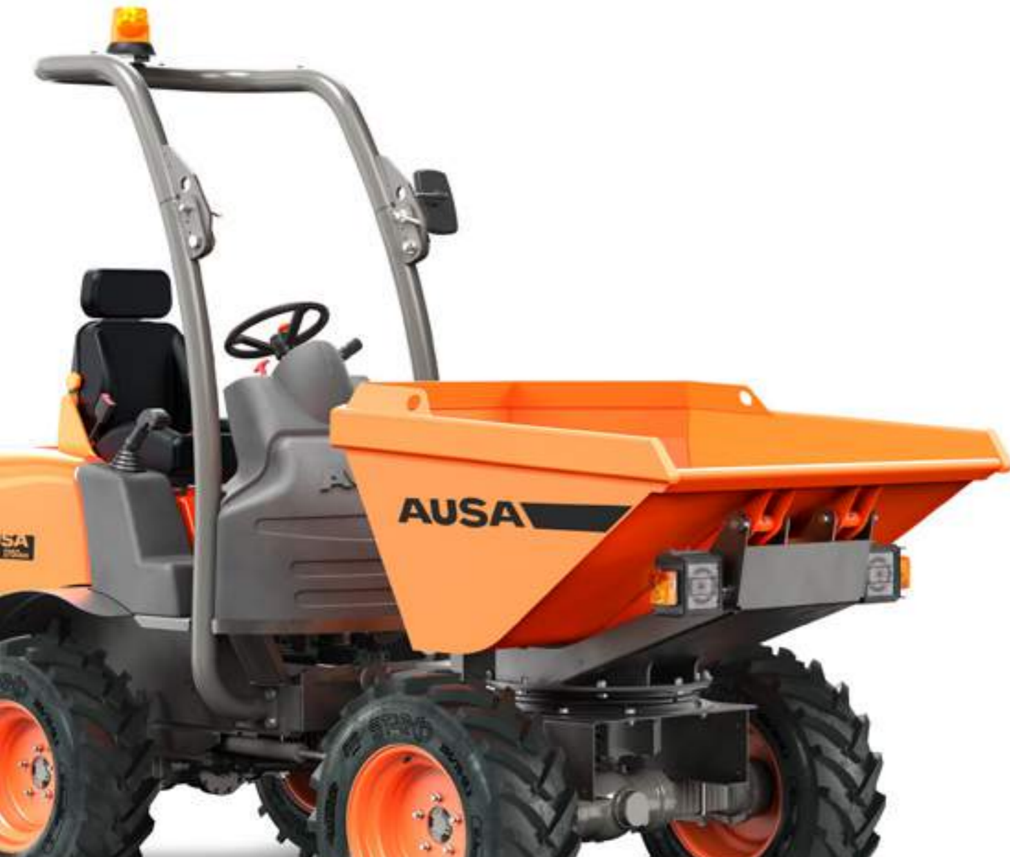
D150AHG 1.500KG ENTLADESYSTEM SCHWENK LEISTUNG 15,6KW BREITE 1.480MM KRAFTÜBERTRAGUNG HYDROSTATIK
