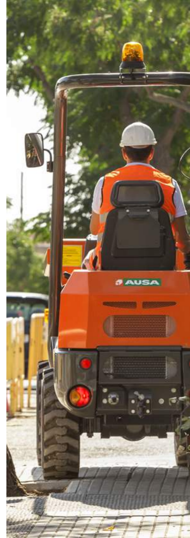
D100AHG 1000KG ENTLADESYSTEM SCHWENK LEISTUNG 15,6KW BREITE 1.100MM KRAFTÜBERTRAGUNG HYDROSTATIK
