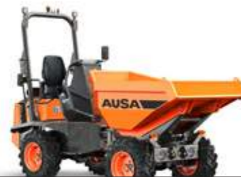
D201AHG 2000KG ENTLADESYSTEM SCHWENK LEISTUNG 18,5KW BREITE 1.500MM KRAFTÜBERTRAGUNG HYDROSTATIK
