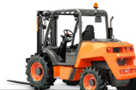
C251H 2500KG ANTRIEB 4x2 / 4x4 FULLGRIP® LEISTUNG 31.2KW BREITE 1520MM ANTRIEB HYDROSTATISCH
