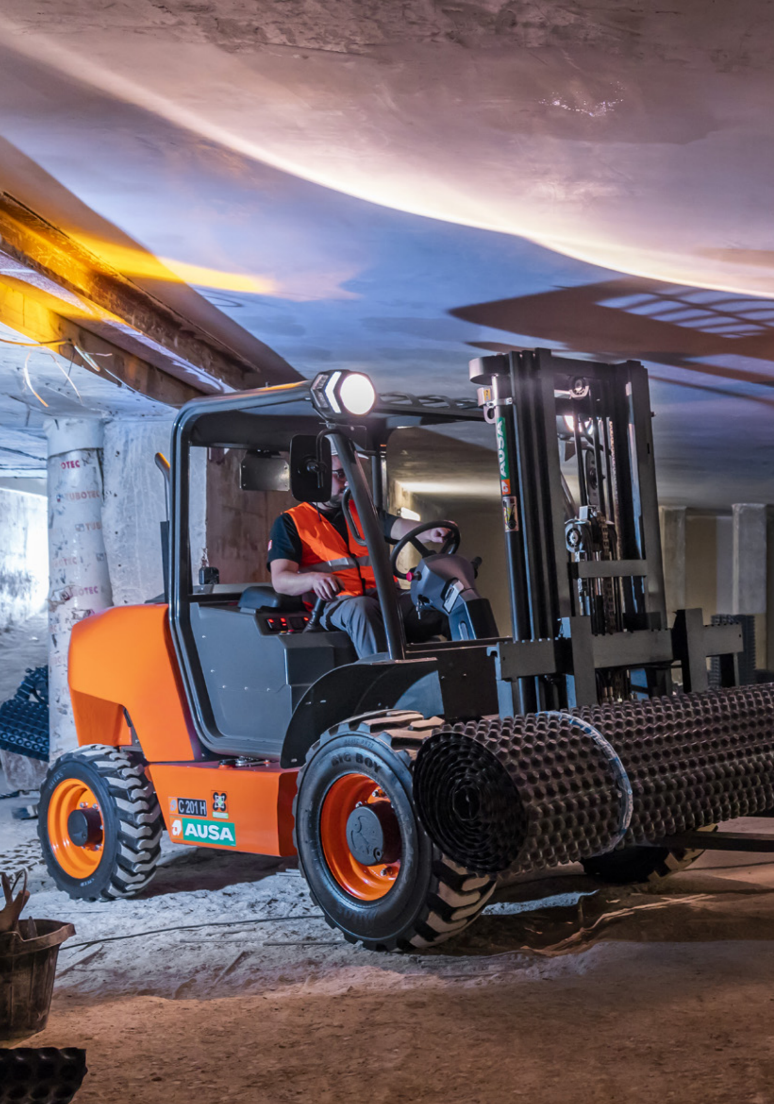
C201H 2000KG ANTRIEB 4x2 / 4x4 FULLGRIP® LEISTUNG 18.5KW BREITE 1520MM ANTRIEB HYDROSTATISCH
