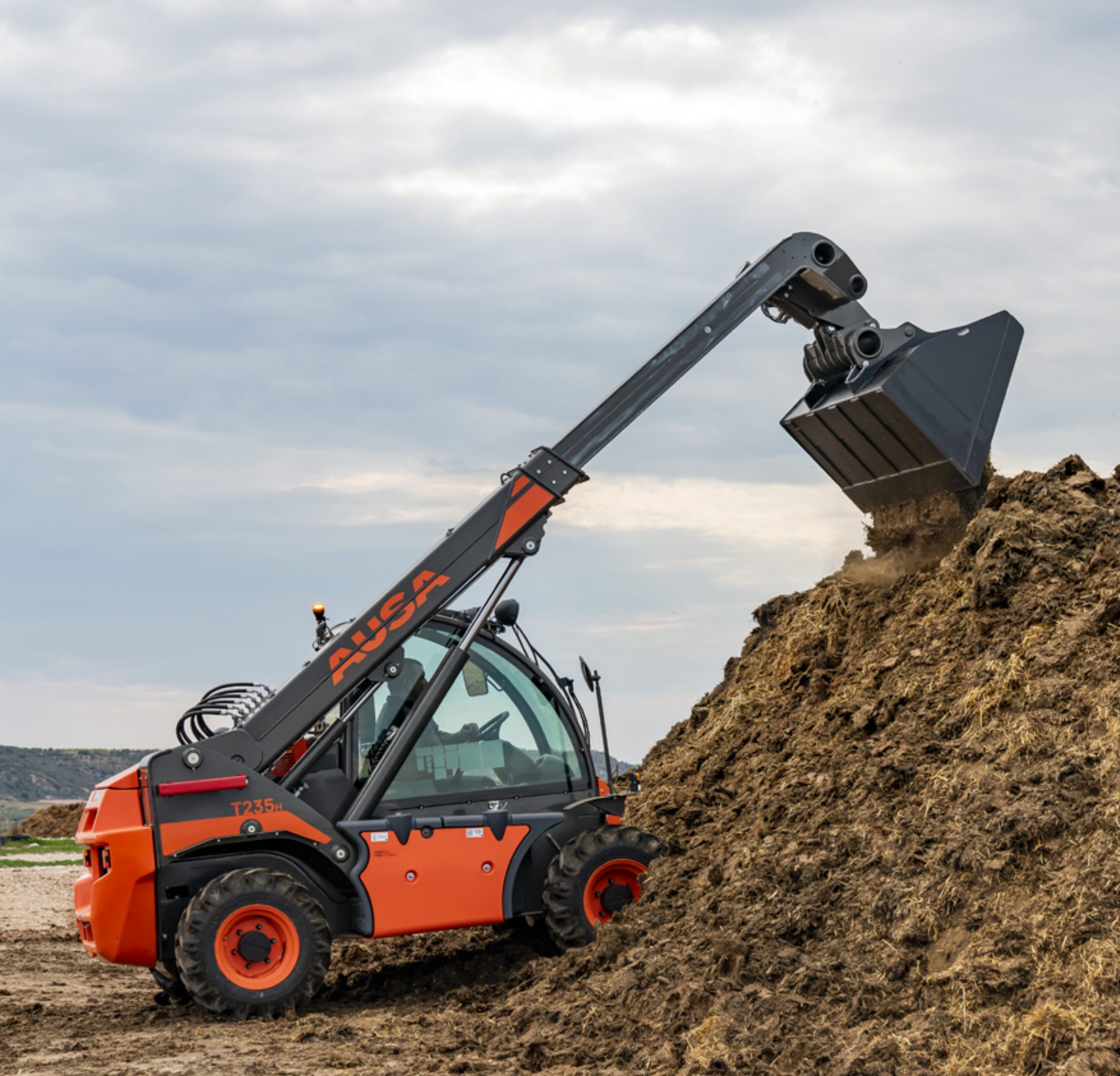
T204H 2000KG MAXIMALE HUBHÖHE 4.300MM LEISTUNG 32,8KW BREITE 1.590MM ANTRIEB HYDROSTATISCH
