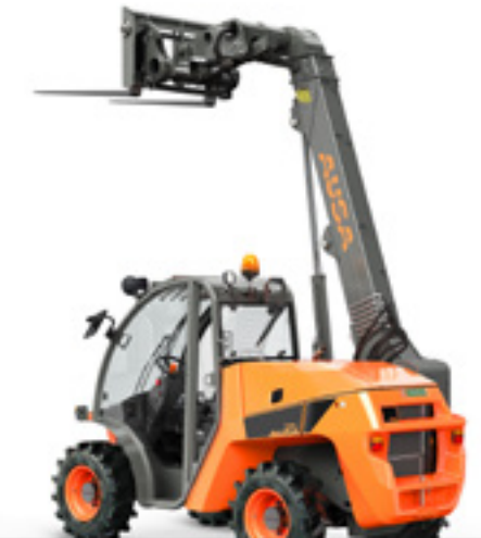
T204H 2000KG MAXIMALE HUBHÖHE 4.300MM LEISTUNG 32,8KW BREITE 1.590MM ANTRIEB HYDROSTATISCH
