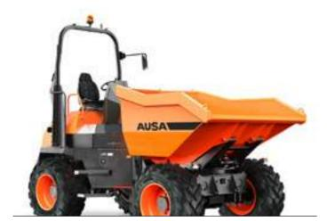
D1001APG 10000KG UNLOADING SYSTEM SWIVEL TIP **POWER** 55.4KW **WIDTH** 2,410MM **TRANSMISSION** TORQUE CONVERTER
