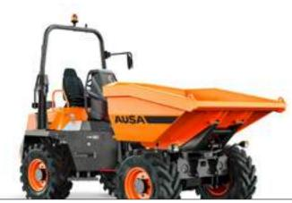
D601AHG+ 6000KG UNLOADING SYSTEM SWIVEL TIP
