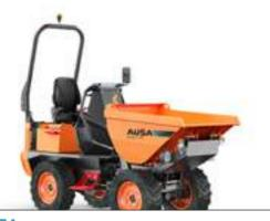
D101AEA 1000KG UNLOADING SYSTEM HIGH TIP POWER 19.6KW WIDTH 1,090MM TRANSMISSION ELECTRIC
