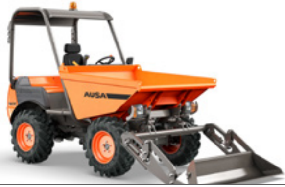
D201RH/RHS 2000KG DÉCHARGEMENT FRONTAL TRACTION 4x4 PUISSANCE 18,5KW LARGEUR 1 750MM TRANSMISSION HYDROSTATIQUE
