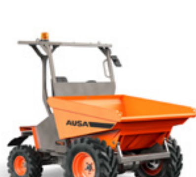
D150RM 1500KG DÉCHARGEMENT FRONTAL TRACTION 4x2 PUISSANCE 12,1KW LARGEUR 1 560MM TRANSMISSION MÉCANIQUE
