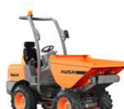
D120AHA 1200KG DÉCHARGEMENT FRONTAL EN HAUTEUR PUISSANCE 15,6KW LARGEUR 1 210MM TRANSMISSION HYDROSTATIQUE
