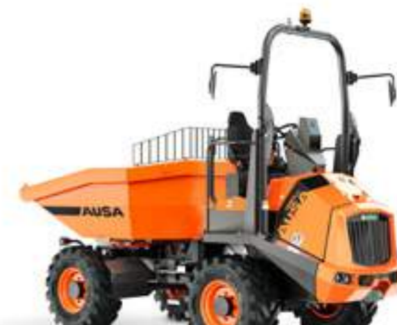
DR601AHG 6000KG DÉCHARGEMENT GIRATOIRE PUISSANCE 55,4KW LARGEUR 2 210MM TRANSMISSION HYDROSTATIQUE
