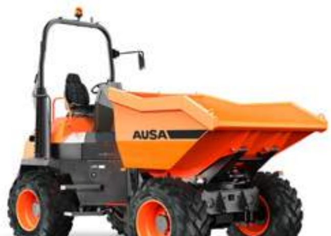
D1001APG 10000KG DÉCHARGEMENT GIRATOIRE PUISSANCE 55,4KW LARGEUR 2 410MM TRANSMISSION CONVERTISSEUR DE COUPLE
