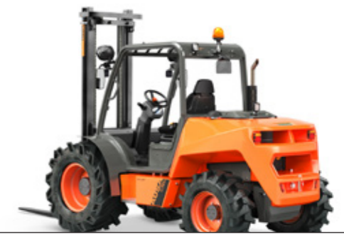
C351H 3500KG TRACTION 4x4 PUISSANCE 31,2KW LARGEUR 1 780MM TRANSMISSION HYDROSTATIQUE
