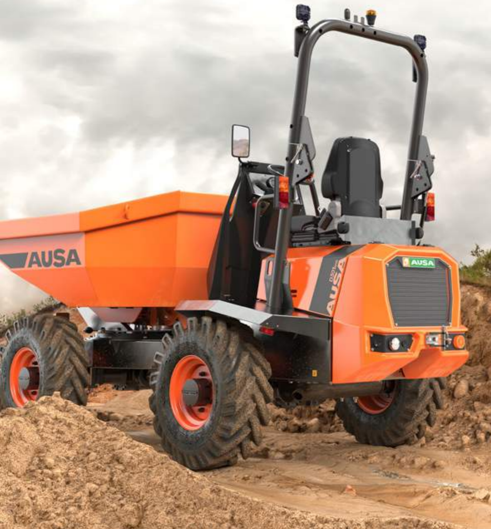
D201AHG 2000KG DÉCHARGEMENT GIRATOIRE PUISSANCE 18,5KW LARGEUR 1 500MM TRANSMISSION HYDROSTATIQUE
