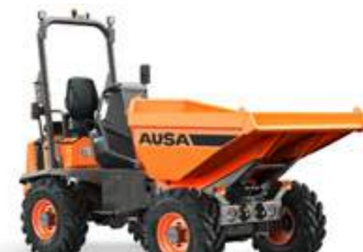
D301AHG 3000KG DÉCHARGEMENT GIRATOIRE PUISSANCE 18,5KW LARGEUR 1 750MM TRANSMISSION HYDROSTATIQUE
