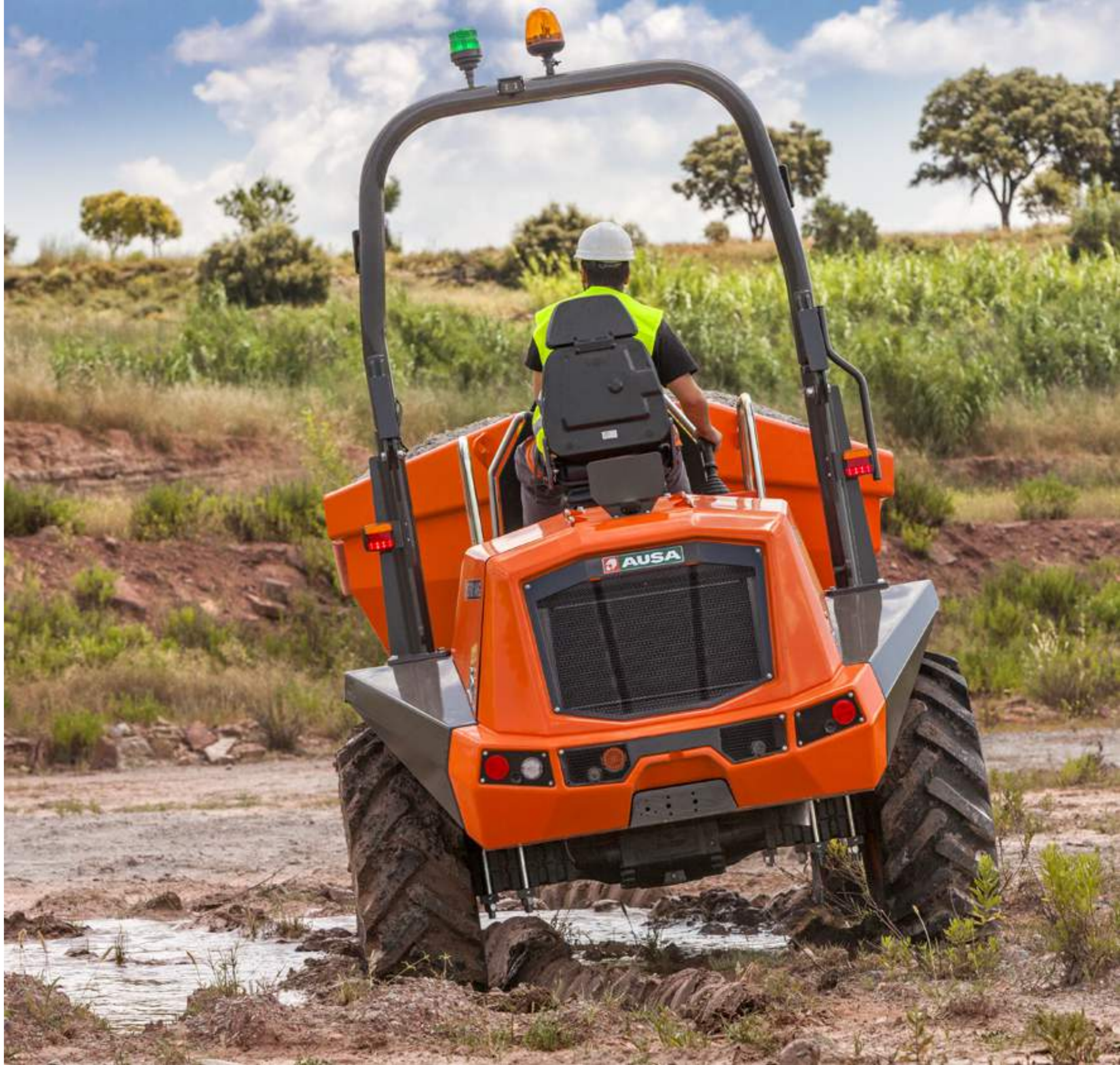
D601AHG 6000KG DÉCHARGEMENT GIRATOIRE PUISSANCE 55,4KW LARGEUR 2 210MM TRANSMISSION HYDROSTATIQUE
