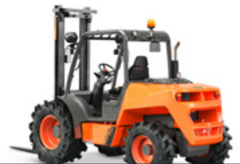
C351H 3500KG TRAZIONE 4x4 FULLGRIP® POTENZA 31,2KW LARGHEZZA 1.780MM TRASMISSIONE IDROSTATICA
