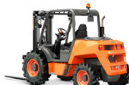
C251H 2500KG TRAZIONE 4x2 / 4x4 FULLGRIP® POTENZA 31,2KW LARGHEZZA 1.520MM TRASMISSIONE IDROSTATICA
