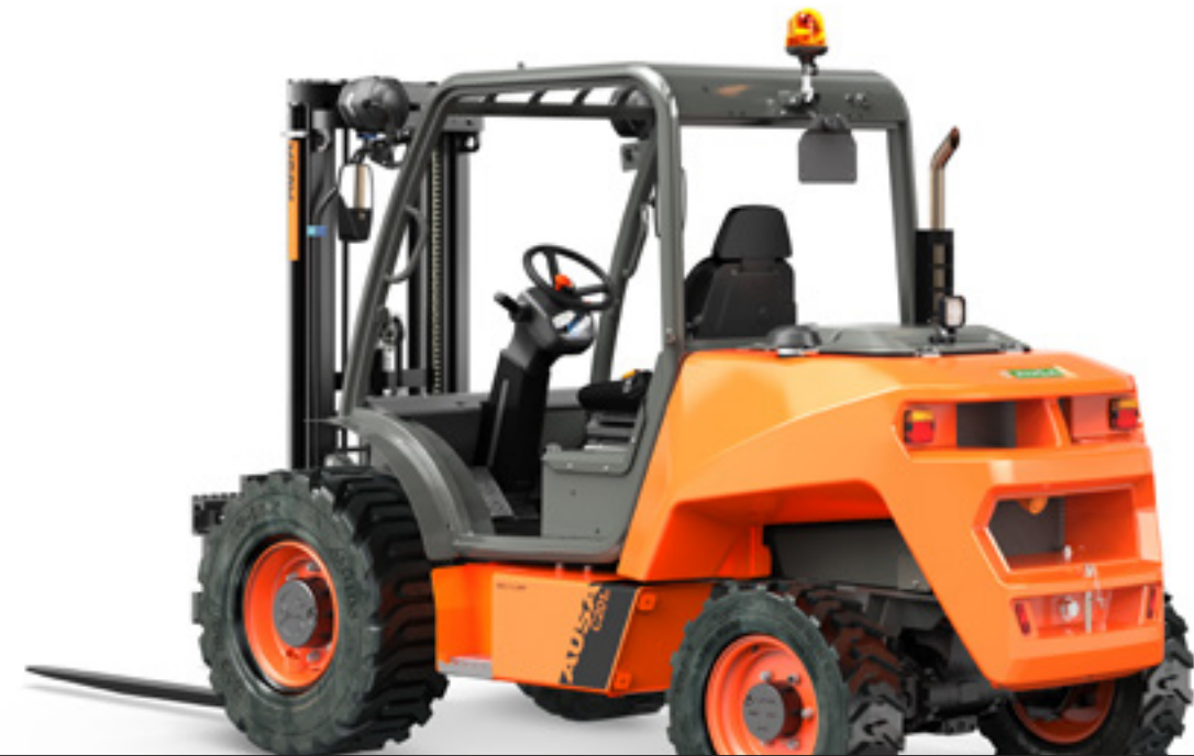
C201H 2000KG TRAZIONE 4x2 / 4x4 FULLGRIP® POTENZA 18,5KW LARGHEZZA 1.520MM TRASMISSIONE IDROSTATICA
