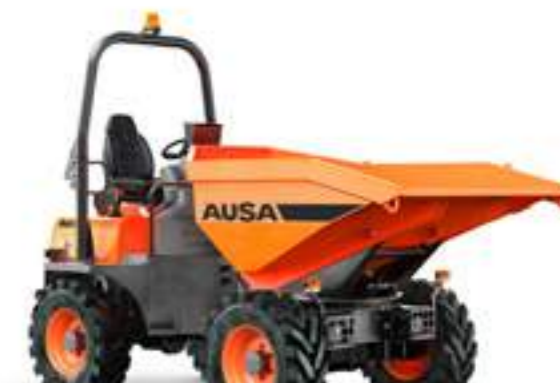
D450AHG 4500KG SCARICO GIREVOLE POTENZA 32,8KW LARGHEZZA 1.870MM TRASMISSIONE IDROSTATICA
