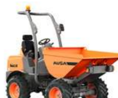
D150AHA 1500KG SCARICO ALTEZZA POTENZA 15,6KW LARGHEZZA 1.480MM TRASMISSIONE IDROSTATICA
