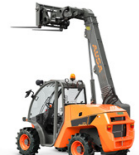
T204H 2000KG SOLLEVAMENTO MASSIMO 4.300MM POTENZA 32,8KW LARGHEZZA 1.590MM TRASMISSIONE IDROSTATICA
