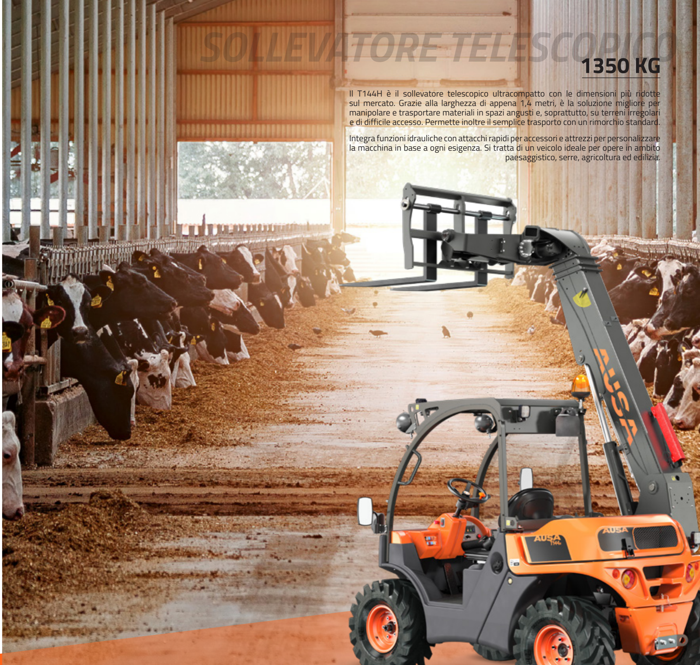
T144H 1350 KG SOLLEVAMENTO MASSIMO 4.000MM POTENZA 18,5KW LARGHEZZA 1.405MM TRASMISSIONE IDROSTATICA
