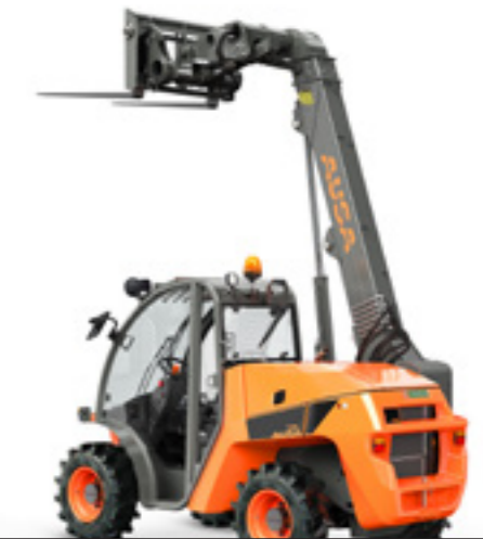
T235H 2300KG SOLLEVAMENTO MASSIMO 4.992MM POTENZA 32,8KW LARGHEZZA 1.590MM TRASMISSIONE IDROSTATICA
