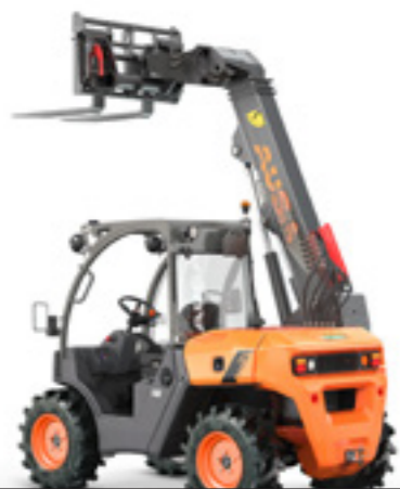
T164H 1600 KG SOLLEVAMENTO MASSIMO 4.000MM POTENZA 18,5KW LARGHEZZA 1.480MM TRASMISSIONE IDROSTATICA
