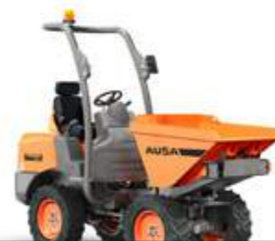
D100AHG 1000KG LOSSYSTEEM DRAAIEND VERMOGEN 15.6KW BREEDTE 1,100MM TRANSMISSIE HYDROSTATISCH
