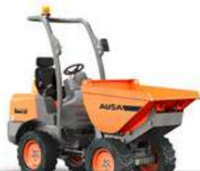
D100AHA 1000KG LOSSYSTEEM HOOG VERMOGEN 15.6KW BREEDTE 1,100MM TRANSMISSIE HYDROSTATISCH
