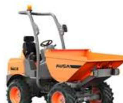
D150AHA 1500KG LOSSYSTEEM HOOG VERMOGEN 15.6KW BREEDTE 1,480MM TRANSMISSIE HYDROSTATISCH
