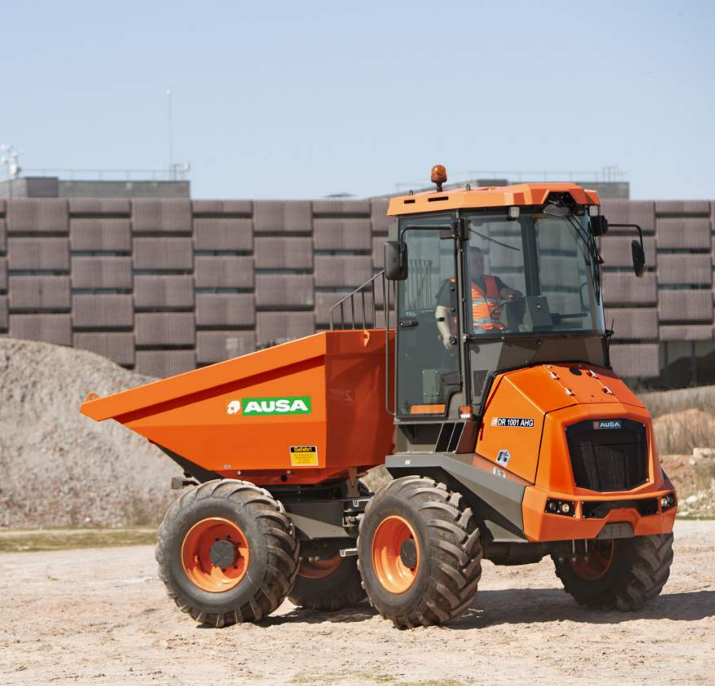
DR601AHG 6000KG LOSSYSTEEM DRAAIEND VERMOGEN 55,4KW BREEDTE 2,210MM TRANSMISSIE HYDROSTATISCH
