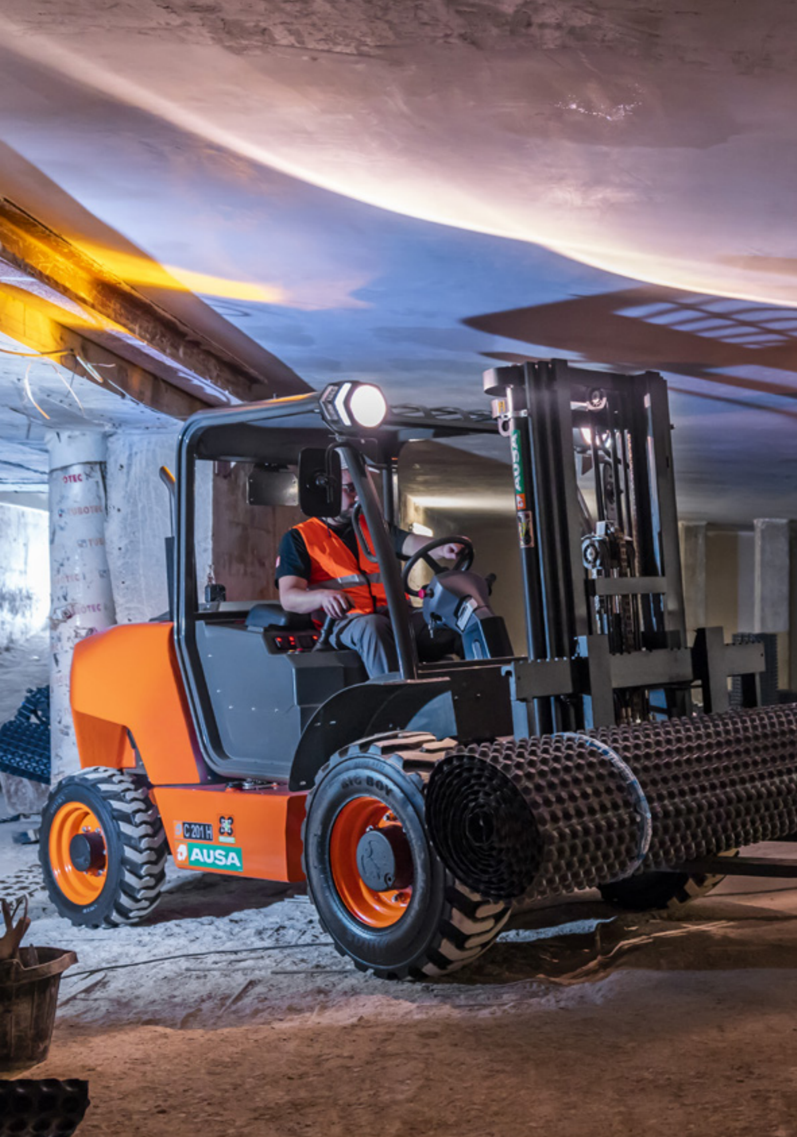
C201H 2000KG TRACTIE 4x2 / 4x4 FULLGRIP® VERMOGEN 18.5KW BREEDTE 1520MM TRANSMISSIE HYDROSTATISCH
