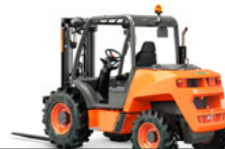
C251H 2500KG TRACTIE 4x2 / 4x4 FULLGRIP® VERMOGEN 31.2KW BREEDTE 1520MM TRANSMISSIE HYDROSTATISCH
