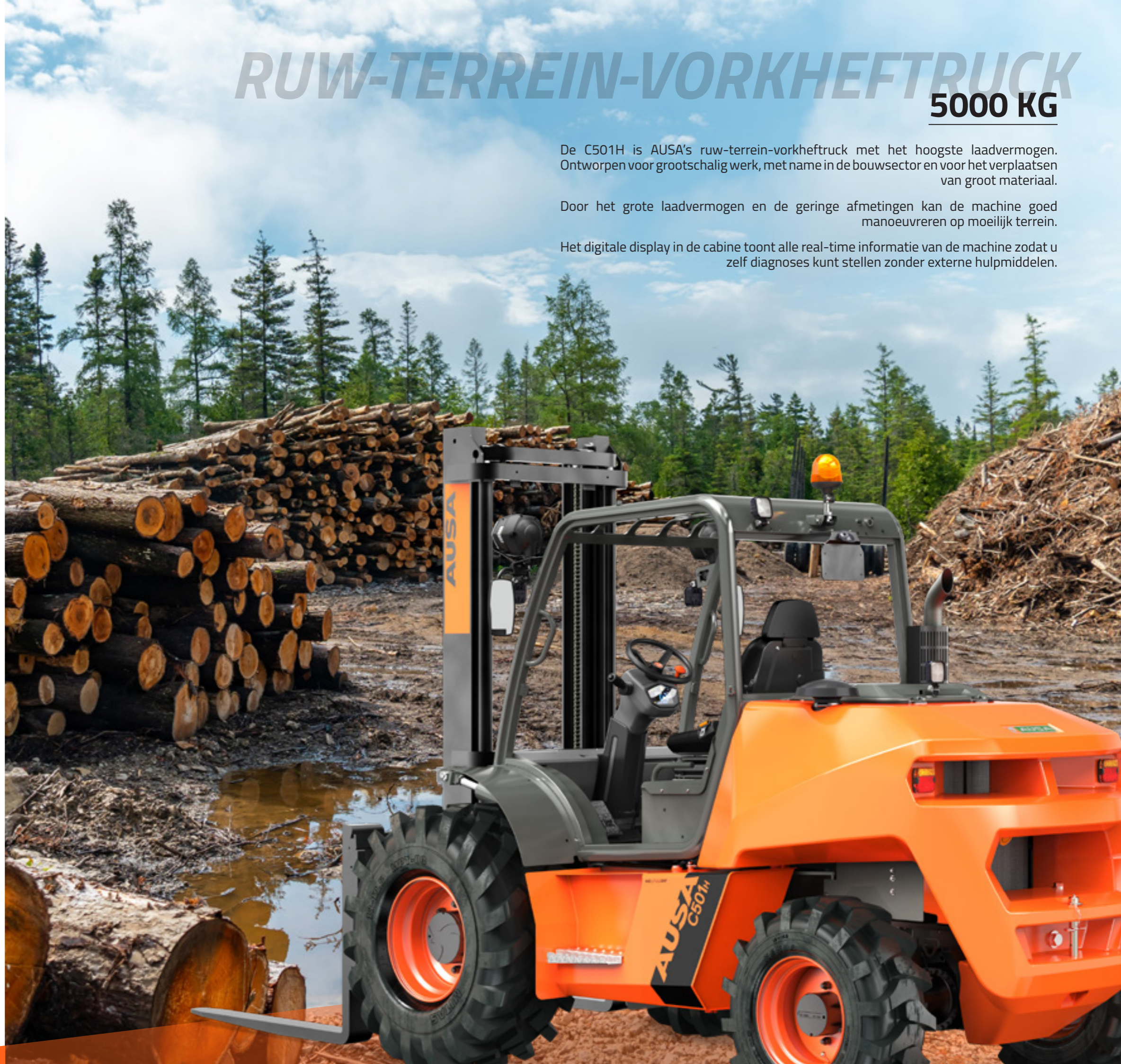
C501H 5000KG TRACTIE 4x4 FULLGRIP® VERMOGEN 55KW BREEDTE 2010MM TRANSMISSIE HYDROSTATISCH
