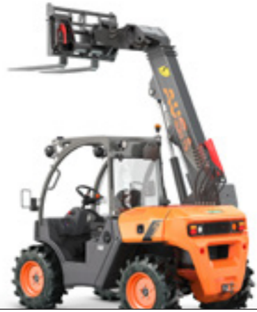
T164H 1600 KG MAXIMALE HEF 4,000MM VERMOGEN 18,5KW BREEDTE 1,480MM TRANSMISSIE HYDROSTATISCH
