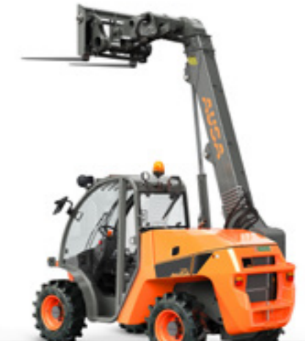
T204H 2000KG MAXIMALE HEF 4,300MM VERMOGEN 32.8KW BREEDTE 1,590MM TRANSMISSIE HYDROSTATISCH
